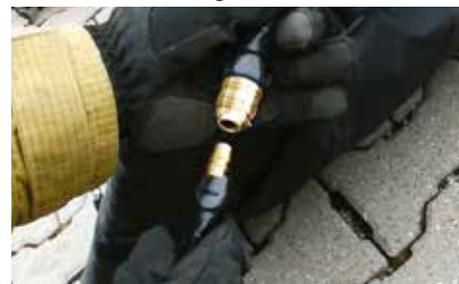
**NOTE IMPORTANTE :** une bonbonne de 6 litres d'air comprimé à 300 bars sera totalement vidée après gonflage des tubes et ne pourra plus être utilisée comme gaz respirable.
